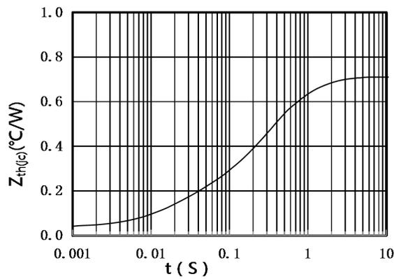
图5.瞬态热阻抗曲线
